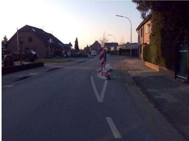
Abbildung 3: Verkehrsinsel (Fa. Lüft) mit Fahrraddurchlaß (Breite ca. 1,00 m)
